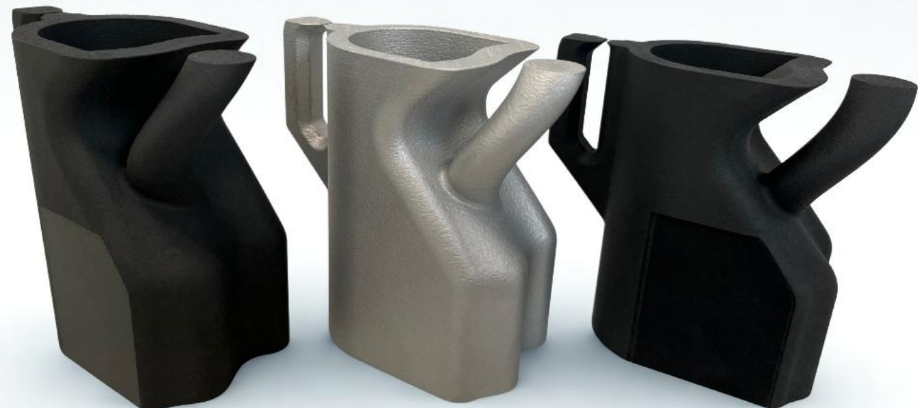
AlSi10Mg Probenoberflächen: Hart eloxiert, Natur eloxiert, Schwarz eloxiert
